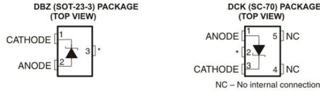
\*電磁干渉が大きいアプリケーション (トランスや他の電磁源の近くに配置した場合など) や、高周波スイッチング ノイズが大きいアプリケーションの場合は、このピンをアノードに接続することを推奨します。高い電磁干渉 (例えば、トランスや他の電磁源の近くに設置される場合) や大きな高周波スイッチング ノイズが存在しない用途では、このピンは未接続 (フローティング) のままにしておくことを検討できます。
