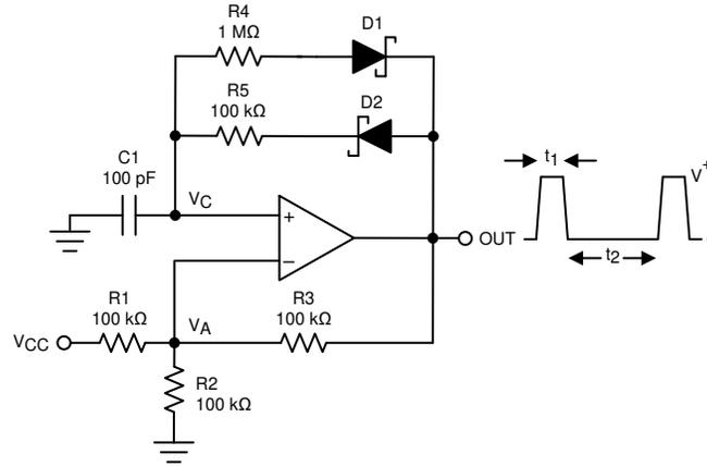
図 7-12. 可変パルス幅ジェネレータ
