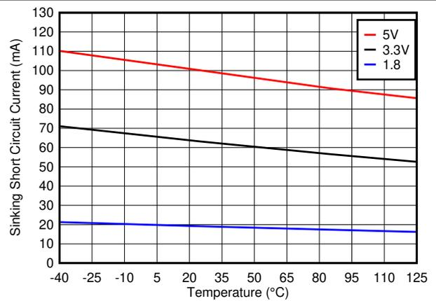
図 5-10. シンク短絡電流と温度の関係
