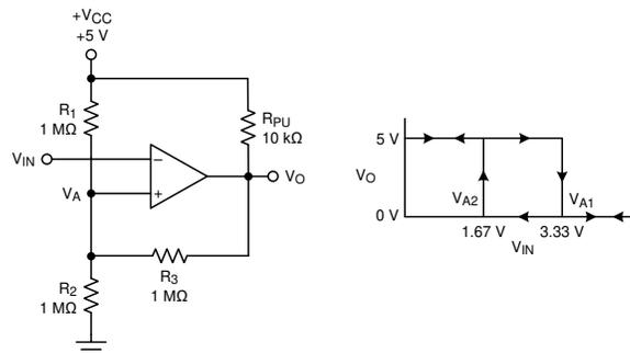
図 7-3. ヒステリシス付きの反転構成
