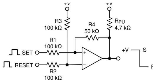
図 7-16. 双安定マルチバイブレータ
