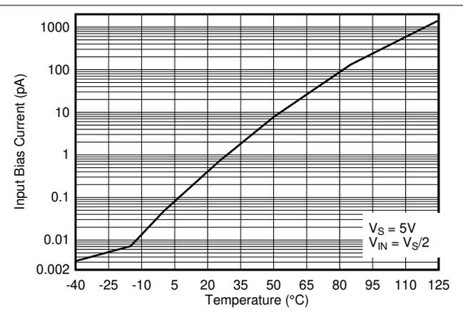
図 5-6. 入力バイアス電流と温度の関係
