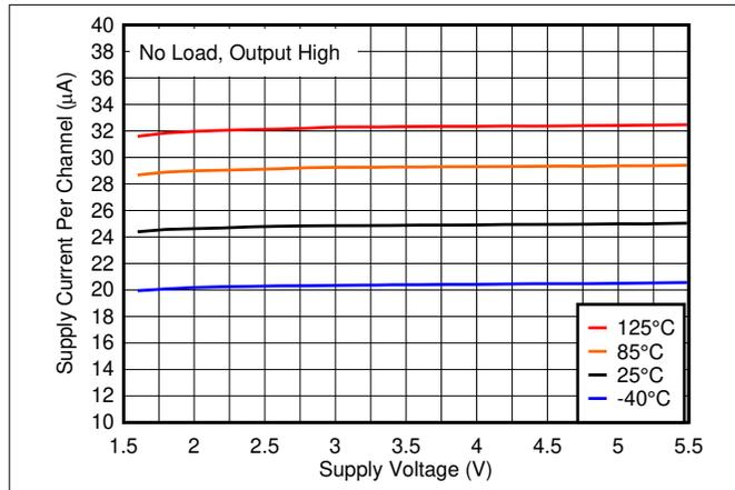
図 5-1. 電源電流と電源電圧の関係
