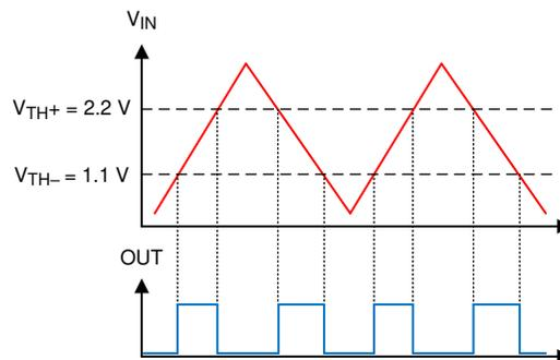
図 7-8. ウィンドウ・コンパレータの結果
