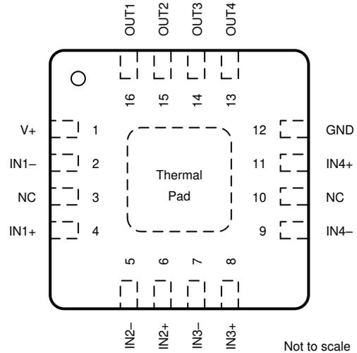
注: 露出サーマル・パッドは GND ピンに直接接続します。
