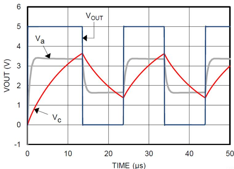
図 7-11. 方形波発振器の出力波形
