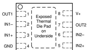
注: 露出サーマル・パッドは GND ピンに直接接続します。
