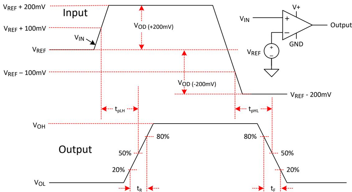
図 7-1. コンパレータのタイミング図
