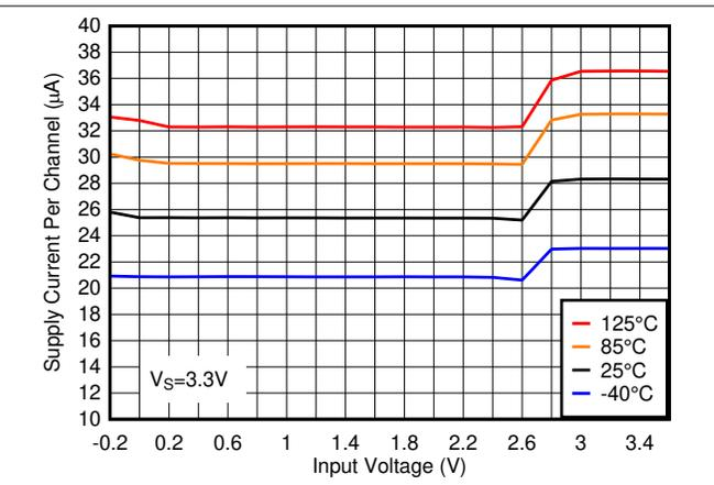
図 5-4. 電源電流と入力電圧、3.3V
