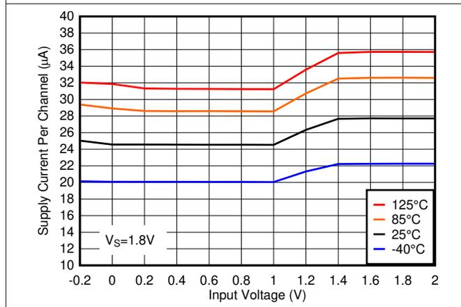
図 5-3. 電源電流と入力電圧、1.8V
