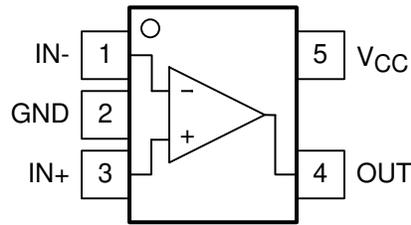
同様の一般的なピン配置と比較して、入力が逆になっている
