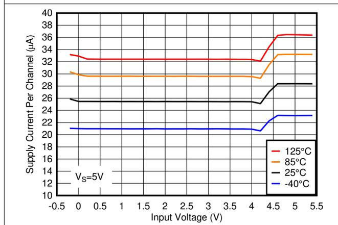
図 5-5. 電源電流と入力電圧、5V
