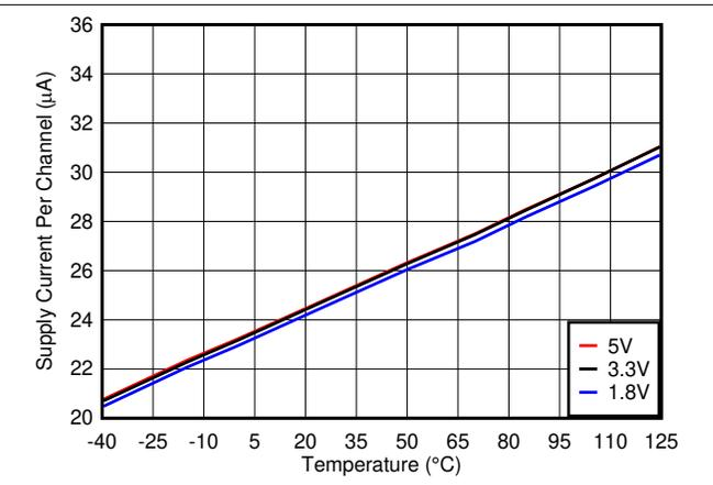
図 5-2. 電源電流と温度の関係
