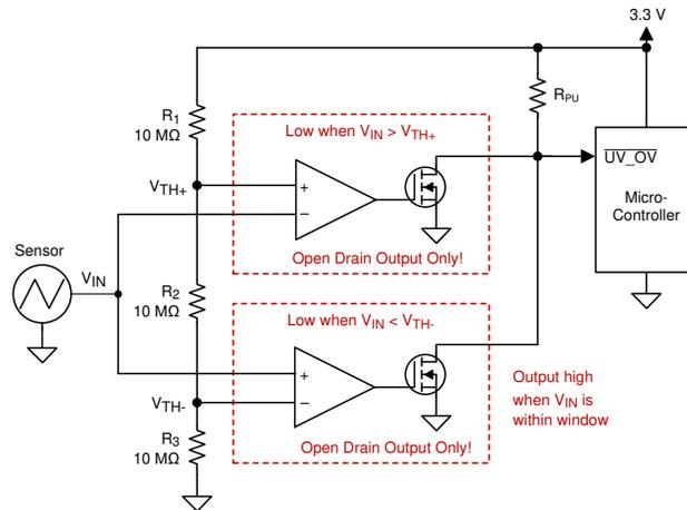
図 7-7. ウィンドウ・コンパレータ
