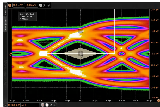
図 7-6. シグナル コンディショニング用の TDP2004-Q1 を使用した TP3_EQ における DP 2.1 Tx コンプライアンス アイ ダイアグラム
