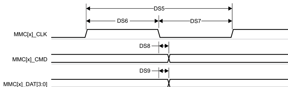
図 6-90. MMC1/2 – デフォルト速度 – 送信モード
