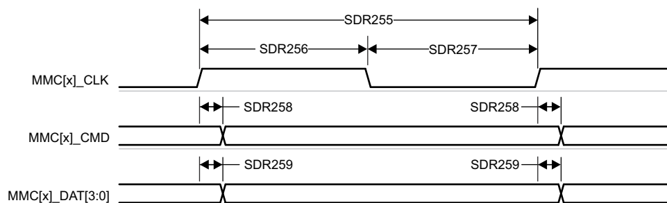
図 6-93. MMC1/2 – UHS-I SDR25 – 送信モード
