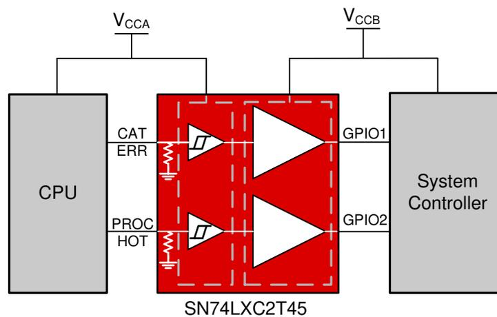
図 17-1. GPIO ドライバ・アプリケーション
