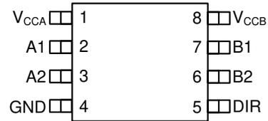
図 5-2. DCU パッケージ、8 ピン VSSOP (上面図)
