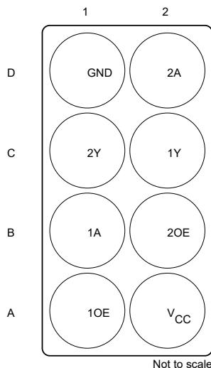
**図 5-2. YZP Package 8-Pin DSBGA Bottom View**
