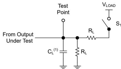
(1)  $C_L$  にはプローブとテスト装置の容量が含まれます。
