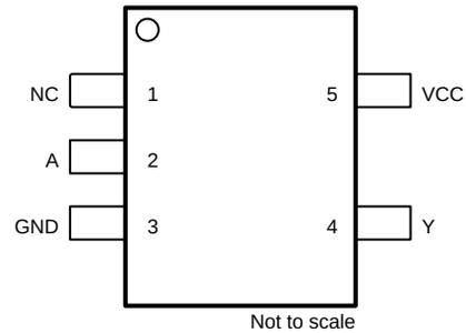
図 4-2. SN74LVC1G16 DCK パッケージ、5 ピン SOT-SC70 (上面図)
