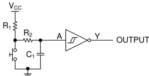
図 7-1. プッシュボタン デバウンス回路図
