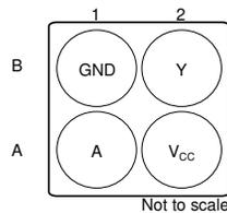
図 4-8. YZV パッケージ 4 ピン DSBGA 底面図
