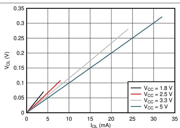
図 5-2. 典型的な V<sub>OL</sub> と I<sub>OL</sub> との関係 - 25°C
