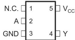
図 4-3. DRL パッケージ 5 ピン SOT-5X3 上面図
