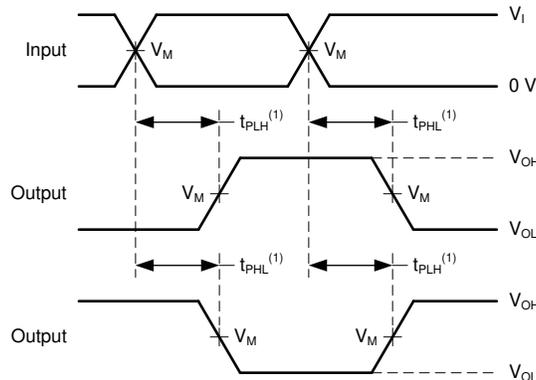
A.  $t_{pd}$  の最大値は、 $t_{PLH}$  または  $t_{PHL}$  のワーストケースとなります
