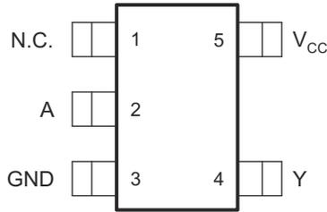
図 4-1. DBV パッケージ 5 ピン SOT-23 上面図
