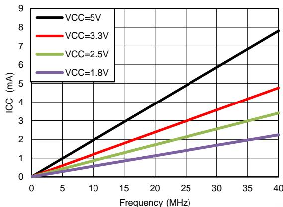
図 8.  $I_{CC}$  vs Frequency
