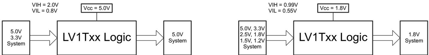
図 7-2. LVxT の昇圧および降圧変換の例
