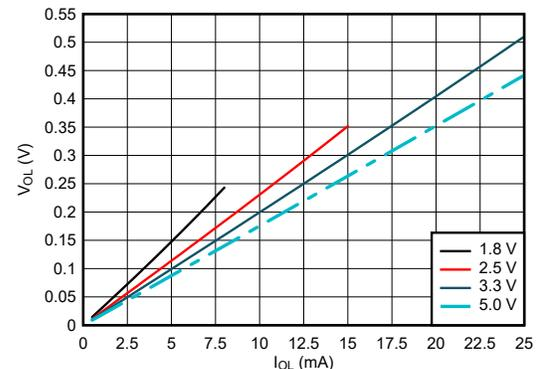
図 5-4. 出力電圧と Low 状態の電流との関係
