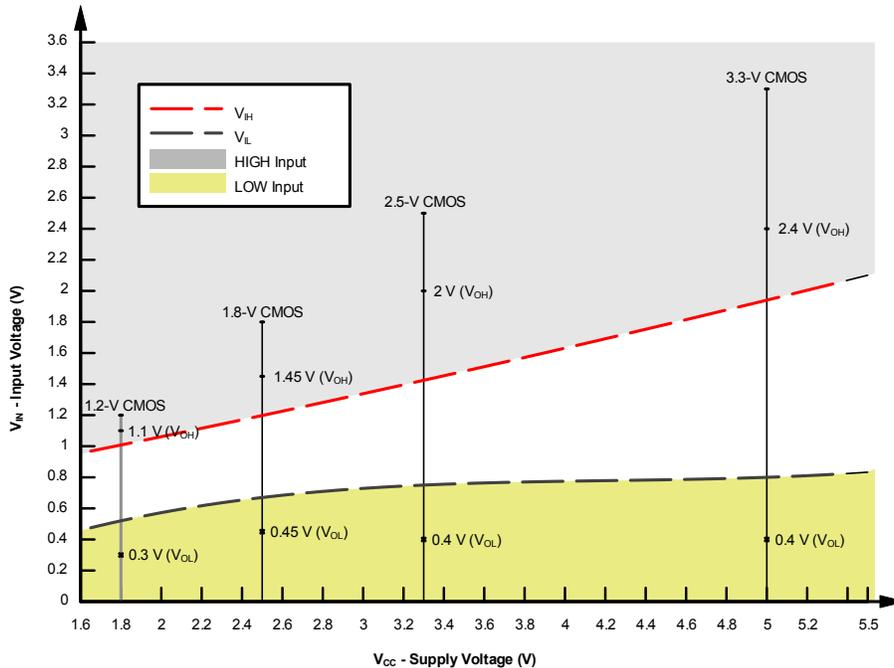
図 7-1. LVxT の入力電圧レベル
