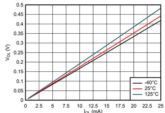
図 5-6. Low 状態における出力電圧と電流の関係、5V 電源
