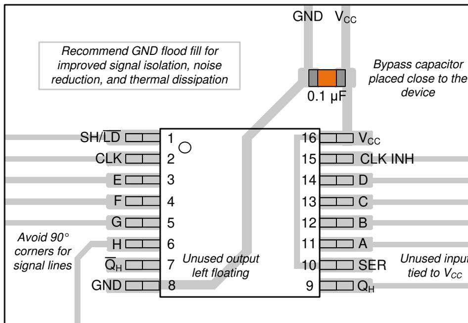
図 8-3. TSSOP の SN74LV8T165 のレイアウト例
