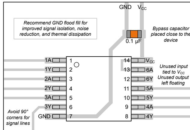
図 9-3. SN74LV6T06 のレイアウト例
