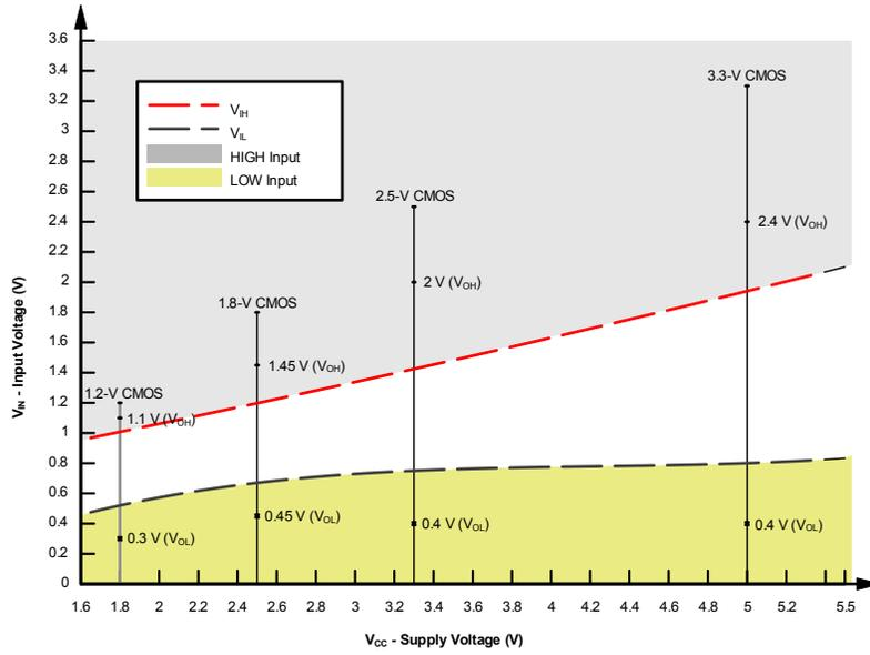
図 8-1. LVxT の入力電圧レベル
