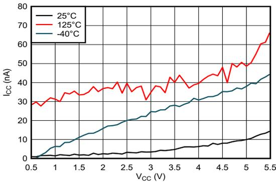
図 6-3. 電源電流と電源電圧との関係
