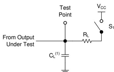
(1) C<sub>L</sub> にはプローブとテスト装置の容量が含まれます。
