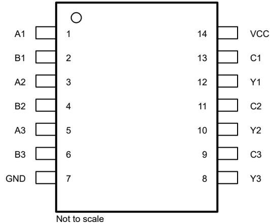
図 4-1. PW パッケージ、14 ピン TSSOP (上面図)
