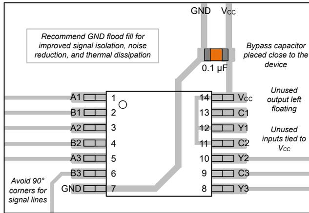
図 8-3. SN74LV3T98-EP のレイアウト例
