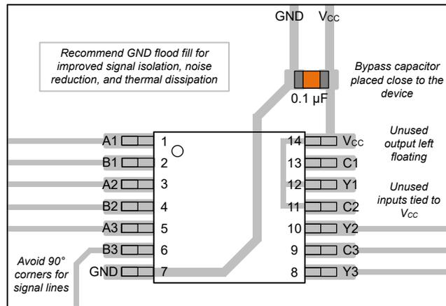
図 8-3. SN74LV3T97-EP のレイアウト例
