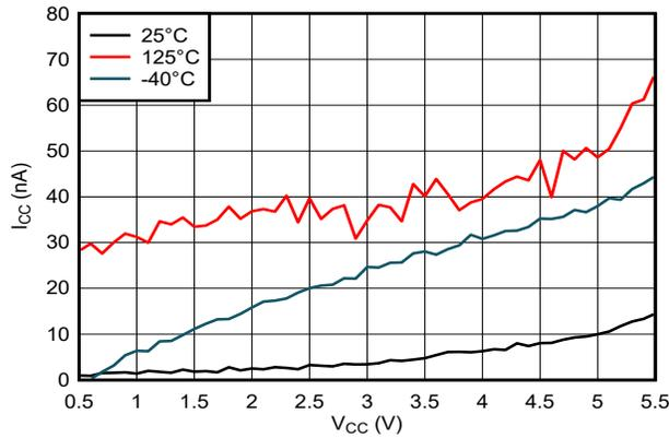
図 5-3. 電源電流と電源電圧との関係
