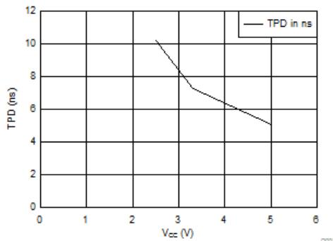
図 6-1. TPD vs  $V_{CC}$
