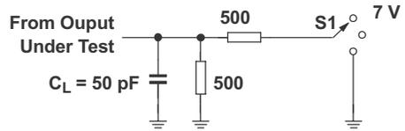
図 7-4. Load Circuit
