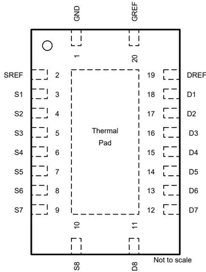
图 5-1. RKS Package, 20-Pin VQFN (Top View)
