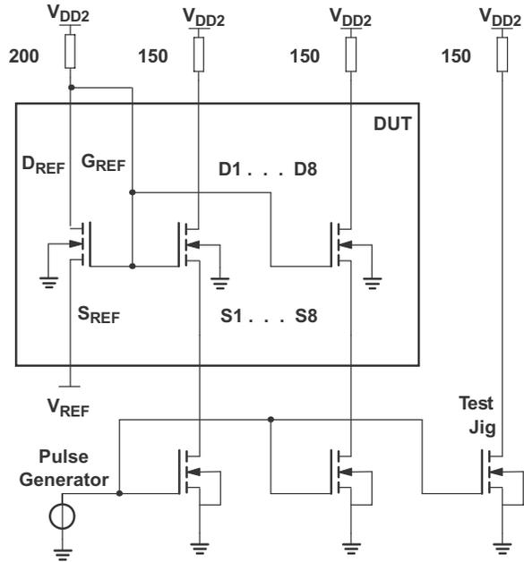
図 7-2. Load Circuit
