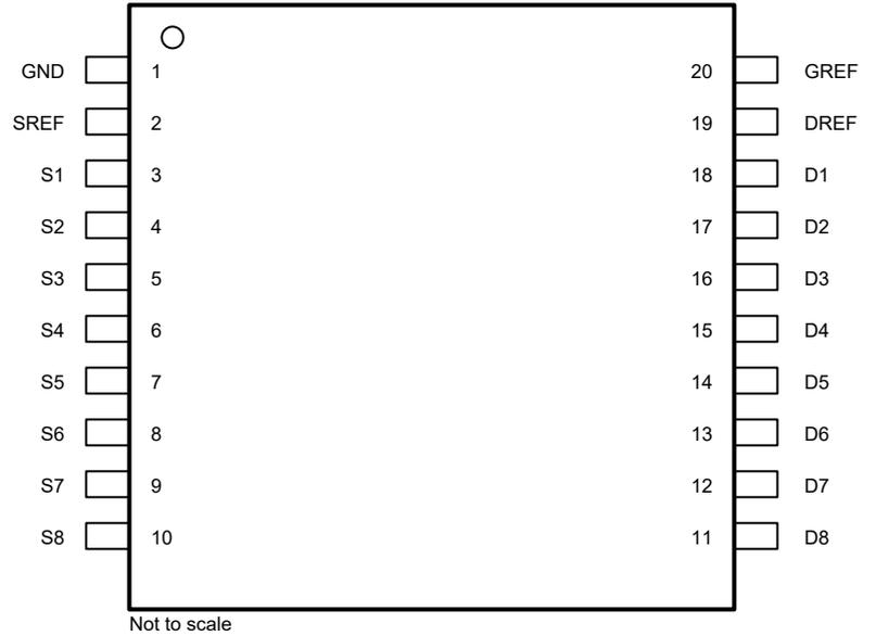
图 5-2. PW Package, 20-Pin TSSOP (Top View)
