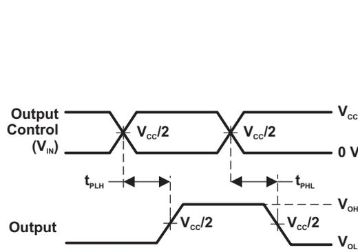
VOLTAGE WAVEFORMS PROPAGATION DELAY TIMES (t<sub>pd(s)</sub>)
