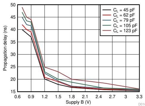
$T_A = 25^\circ\text{C}$     $V_{CCA} = 0.7\text{V}$
