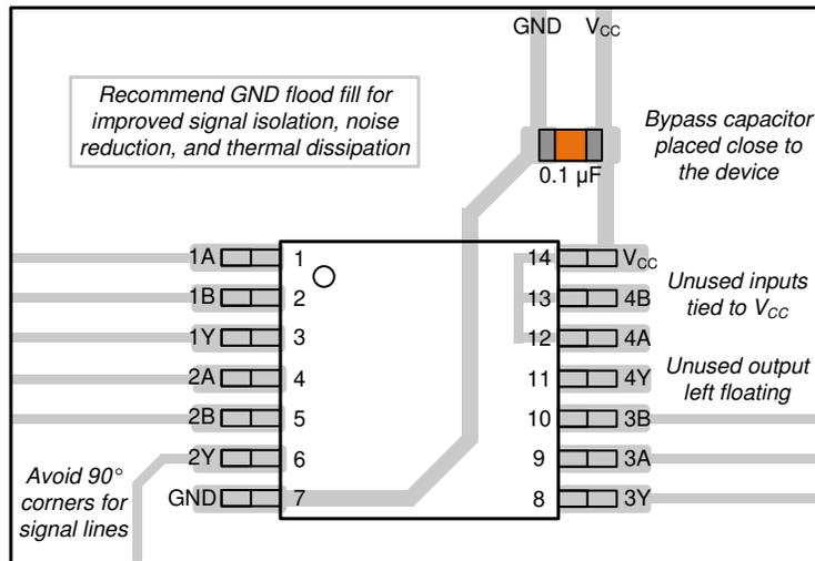
図 8-3. SN74AHCT32-Q1 のレイアウト例
