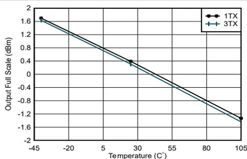
$f_{\text{DAC}} = 11796.48\text{MSPS}$ 、 $A_{\text{OUT}} = -0.5\text{dBFS}$ 、4.9GHz に整合
