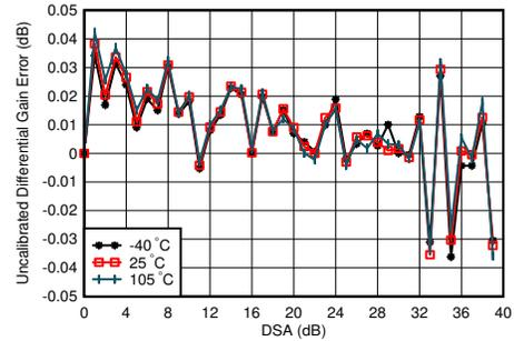
$f_{\text{DAC}} = 11796.48\text{MSPS}$ 、インターリーブモード、4.9GHzで整合微分ゲイン誤差 =  $P_{\text{OUT}}(\text{DSA 設定} - 1) - P_{\text{OUT}}(\text{DSA 設定}) + 1$
