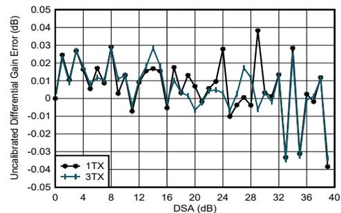
$f_{\text{DAC}} = 5898.24\text{MSPS}$ 、インターリーブモード、 $0.8\text{GHz}$  で整合
