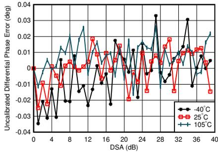
$f_{\text{DAC}} = 8847.36\text{MSPS}$ 、ストレートモード、2.6GHzで整合、全  $\text{DSA}$  設定にわたって  $25^\circ\text{C}$ での誤差が中央値であるチャンネル微分位相誤差 =  $\text{Phase}_{\text{OUT}}(\text{DSA 設定} - 1) - \text{Phase}_{\text{OUT}}(\text{DSA 設定})$
