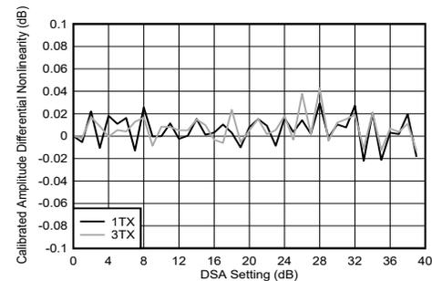
図 4-188. TX DSA 較正済み振幅の微分非直線性 (8.11GHz)
