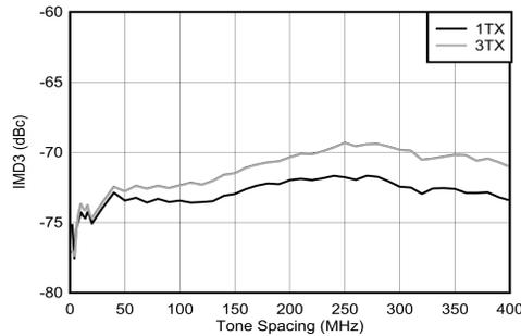
$f_{\text{DAC}} = 8847.36\text{MSPS}$ 、ストレートモード、 $f_{\text{CENTER}} = 2.6\text{GHz}$ 、 $2.6\text{GHz}$  で整合、各トーン  $-13\text{dBFS}$
