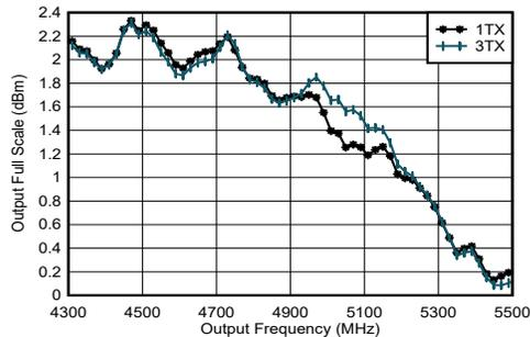
PCB とケーブルの損失を除く。 $A_{\text{OUT}} = -0.5\text{dBFS}$ 、 $\text{DSA} = 0$ 、4.9GHz 整合あり。
