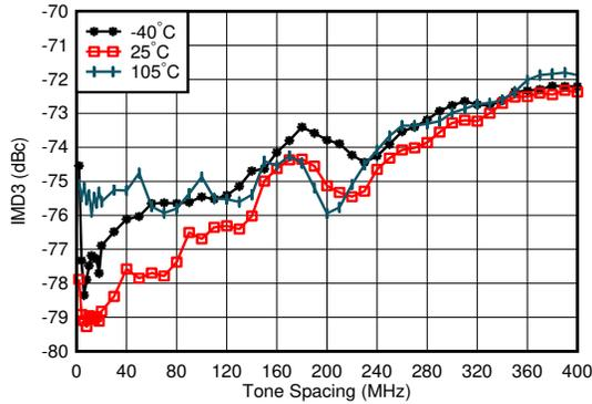
$f_{\text{DAC}} = 5898.24\text{MSPS}$ 、ストレートモード、 $f_{\text{CENTER}} = 0.85\text{GHz}$ 、 $0.8\text{GHz}$ で整合、各トーン  $-13\text{dBFS}$ 、ワーストチャネル
