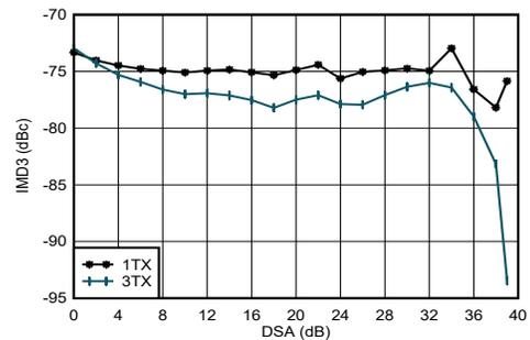
$f_{\text{DAC}} = 8847.36\text{MSPS}$ 、ストレートモード、 $f_{\text{CENTER}} = 2.6\text{GHz}$ 、2.6GHzで整合、各トーン  $-13\text{dBFS}$
