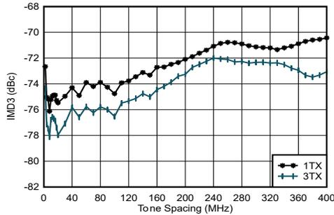
$f_{DAC} = 11796.48\text{MSPS}$ 、インターリーブモード、 $f_{CENTER} = 1.8\text{GHz}$ 、 $1.8\text{GHz}$ で整合、各トーン  $-13\text{dBFS}$
