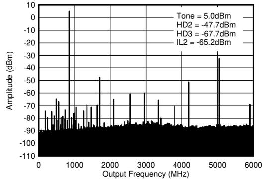
$f_{\text{DAC}} = 5898.24\text{MSPS}$ 、インターリーブモード、0.8GHz 整合あり、PCB とケーブルの損失を含む。ILn =  $f_s/n \pm f_{\text{OUT}}$ 。
