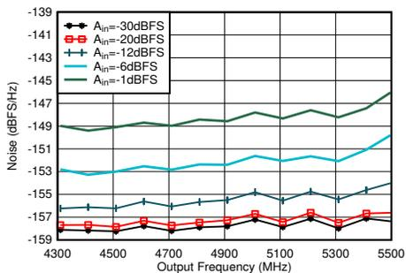
4.9GHzで整合、シングルトーン、 $f_{DAC} = 11.79648\text{GSPS}$ 、インターリーブモード、40MHzオフセット、 $DSA = 0\text{dB}$
