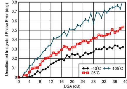
$f_{\text{DAC}} = 11796.48\text{MSPS}$ 、インターリーブモード、4.9GHzで整合
