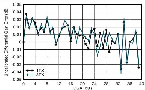
$f_{\text{DAC}} = 11796.48\text{MSPS}$ 、インターリーブモード、4.9GHz で整合
