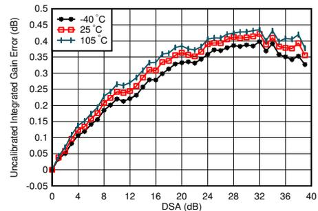
$f_{\text{DAC}} = 11796.48\text{MSPS}$ 、インターリーブモード、4.9GHzで整合積分ゲイン誤差 =  $P_{\text{OUT}}(\text{DSA 設定}) - P_{\text{OUT}}(\text{DSA 設定} = 0) + (\text{DSA 設定})$
