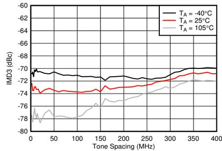
$f_{\text{DAC}} = 8847.36\text{MSPS}$ 、ストレートモード、 $f_{\text{CENTER}} = 2.6\text{GHz}$ 、 $2.6\text{GHz}$  で整合、各トーン  $-13\text{dBFS}$ 、ワーストチャネル
