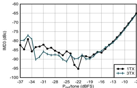
$f_{\text{DAC}} = 8847.36\text{MSPS}$ 、ストレートモード、 $f_{\text{CENTER}} = 0.85\text{GHz}$ 、 $f_{\text{SPACING}} = 20\text{MHz}$ 、 $0.8\text{GHz}$ で整合
