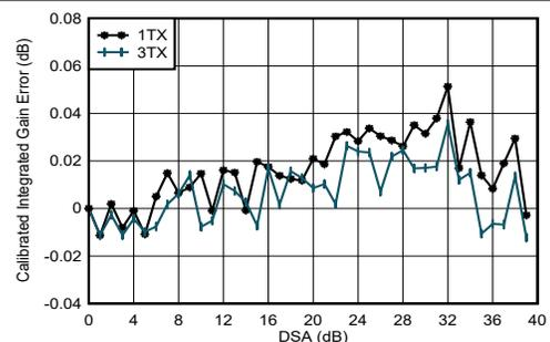
$f_{\text{DAC}} = 8847.36\text{MSPS}$ 、ストレートモード、 $2.6\text{GHz}$  で整合
