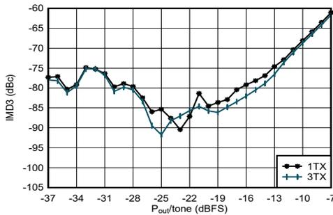
$f_{DAC} = 11796.48\text{MSPS}$ 、インターリーブモード、 $f_{CENTER} = 1.8\text{GHz}$ 、 $f_{SPACING} = 20\text{MHz}$ 、 $1.8\text{GHz}$ で整合
