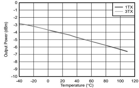
PCB とケーブルの損失を含む。
