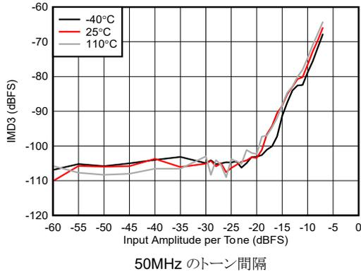
図 4-428. RX IMD3 と入力振幅との関係 (8.1GHz)
