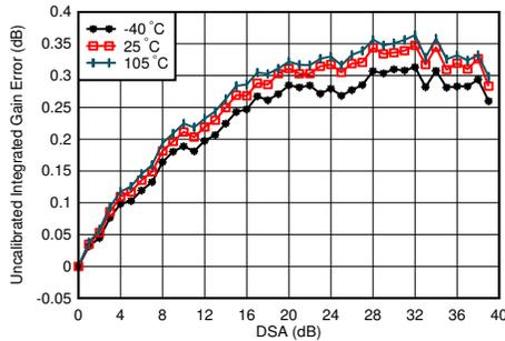
$f_{\text{DAC}} = 8847.36\text{MSPS}$ 、ストレートモード、2.6GHz で整合、全  $\text{DSA}$  設定にわたって  $25^\circ\text{C}$ での誤差が中央値であるチャンネル積分ゲイン誤差 =  $P_{\text{OUT}}(\text{DSA 設定}) - P_{\text{OUT}}(\text{DSA 設定} = 0) + (\text{DSA 設定})$
