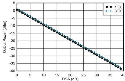
$A_{\text{out}} = -0.5\text{dBFS}$ 、3.5GHz 整合あり、PCB とケーブルの損失を含む。
