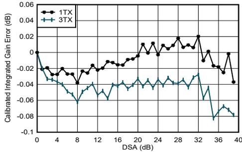
$f_{\text{DAC}} = 11796.48\text{MSPS}$ 、インターリーブモード、4.9GHzで整合積分ゲイン誤差 =  $P_{\text{OUT}}(\text{DSA 設定}) - P_{\text{OUT}}(\text{DSA 設定} = 0) + (\text{DSA 設定})$
