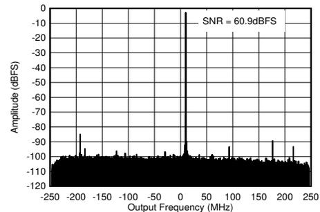
1.8GHz 整合あり、 $f_{\text{IN}} = 2610\text{MHz}$ 、 $A_{\text{IN}} = -3\text{dBFS}$
