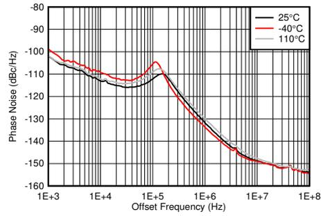
PLL イネーブル、 $f_{VCO} = 7864.32\text{MHz}$ 、 $f_{REF} = 491.52\text{MSPS}$ 、TX 出力で測定
