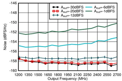
$2.6\text{GHz}$ で整合、シングルトーン、 $f_{DAC} = 11.79648\text{GSPS}$ 、インターリーブモード、 $40\text{MHz}$ オフセット
