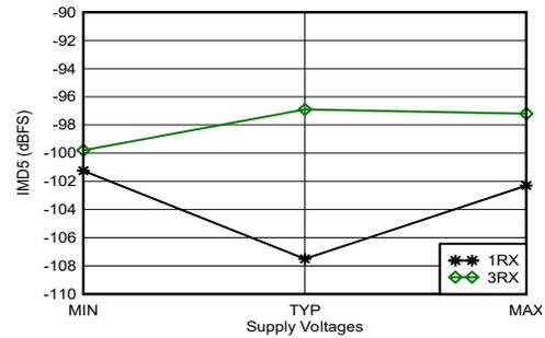
3.6GHz 整合あり、各トーン -7dBFS、20MHz のトーン間隔、すべての電源電圧は推奨動作条件の最小値、代表値、最大値
