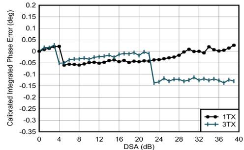
$f_{\text{DAC}} = 5898.24\text{MSPS}$ 、インターリーブモード、1.8GHzで整合
