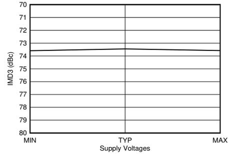
$f_{\text{DAC}} = 11796.48\text{MSPS}$ 、インターリーブモード、2.6GHz 整合あり。トーンから 40MHz オフセット。出力電力 = -13dBFS。すべての電源電圧に最小値、代表値、最大値がある。
