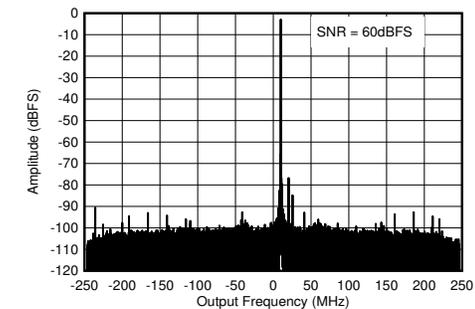
4.9GHz 整合あり、 $f_{\text{IN}} = 4910\text{MHz}$ 、 $A_{\text{IN}} = -3\text{dBFS}$
