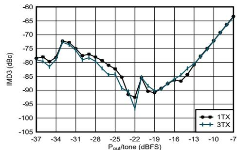
$f_{\text{DAC}} = 11796.48\text{MSPS}$ 、インターリーブモード、 $f_{\text{CENTER}} = 0.85\text{GHz}$ 、 $f_{\text{SPACING}} = 20\text{MHz}$ 、 $0.8\text{GHz}$ で整合
