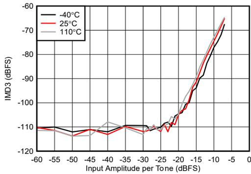
図 4-454. RX IMD3 とデジタル振幅との関係 (9.6GHz)
