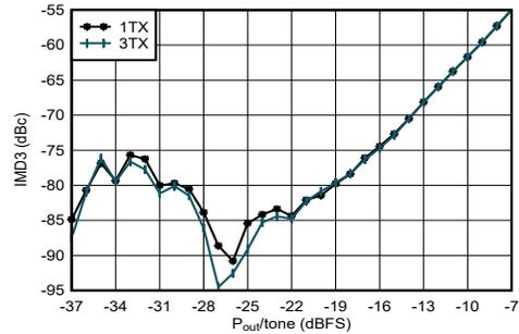
$f_{DAC} = 11796.48\text{MSPS}$ 、インターリーブモード、4.9GHzで整合、 $f_{CENTER} = 4.9\text{GHz}$ 、 $f_{SPACING} = 20\text{MHz}$
