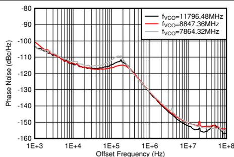
PLL イネーブル、 $f_{\text{REF}} = 491.52\text{MSPS}$ 、TX 出力で測定
