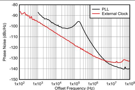
TX 出力で測定、 $20 \times \log_{10}$  で 12GHz に正規化 ( $12\text{GHz}/F_{\text{OUT}}$ )
