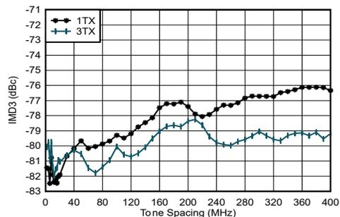
$f_{\text{DAC}} = 8847.36\text{MSPS}$ 、ストレートモード、 $f_{\text{CENTER}} = 0.85\text{GHz}$ 、0.8GHzで整合、各トーン -13dBFS
