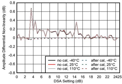
図 4-424. RX 振幅の微分非直線性 (8.11GHz)
