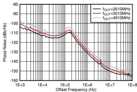
PLL イネーブル、 $f_{VCO} = 8847.36\text{MHz}$ 、 $f_{REF} = 491.52\text{MSPS}$ 、TX 出力で測定
