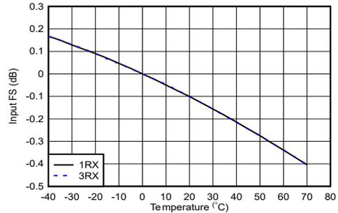
1.8GHz 整合あり、各チャンネルについて  $25^\circ\text{C}$  のフルスケールで正規化
