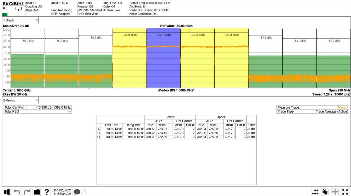
図 4-231. TX 4x100MHz NR 出力スペクトル (8.11GHz)
