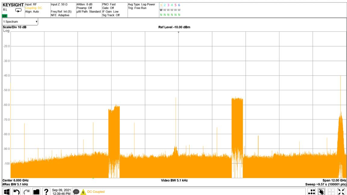
図 4-232. TX 4x100MHz NR 出力スペクトル (8.11GHz)
