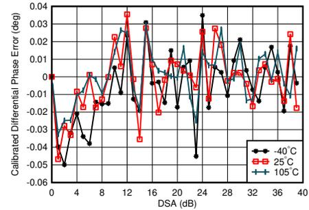
$f_{\text{DAC}} = 8847.36\text{MSPS}$ 、ストレートモード、2.6GHzで整合、全  $\text{DSA}$  設定にわたって  $25^\circ\text{C}$ での誤差が中央値であるチャンネル微分位相誤差 =  $\text{Phase}_{\text{OUT}}(\text{DSA 設定} - 1) - \text{Phase}_{\text{OUT}}(\text{DSA 設定})$
