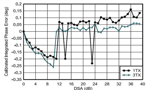
$f_{\text{DAC}} = 8847.36\text{MSPS}$ 、ストレートモード、2.6GHzで整合
