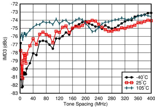
$f_{\text{DAC}} = 11796.48\text{MSPS}$ 、ストレートモード、 $f_{\text{CENTER}} = 0.85\text{GHz}$ 、 $0.8\text{GHz}$ で整合、各トーン  $-13\text{dBFS}$ 、ワーストチャネル
