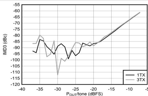
$f_{\text{DAC}} = 8847.36\text{MSPS}$ 、ストレートモード、 $f_{\text{CENTER}} = 2.6\text{GHz}$ 、 $f_{\text{SPACING}} = 20\text{MHz}$ 、 $2.6\text{GHz}$  で整合
