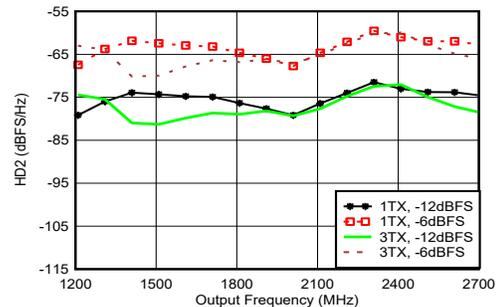
1.8GHz で整合、 $f_{\text{DAC}} = 11.79648\text{GSPS}$ 、インターリーブモード、高調波周波数での出力電力で正規化
