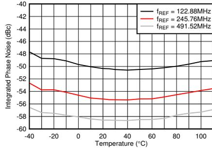
PLL イネーブル、 $f_{VCO} = 9830.4\text{MHz}$ 、1kHz~100MHz、片側積分帯域幅、TX 出力で測定
