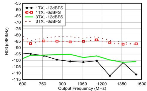
0.8GHz で整合、 $f_{\text{DAC}} = 8847.36\text{MSPS}$ 、ストレートモード、高調波周波数での出力電力で正規化。
