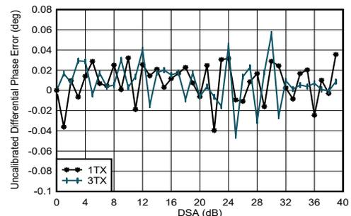
$f_{\text{DAC}} = 11796.48\text{MSPS}$ 、インターリーブモード、4.9GHzで整合微分位相誤差 =  $\text{Phase}_{\text{OUT}}(\text{DSA 設定} - 1) - \text{Phase}_{\text{OUT}}(\text{DSA 設定})$
