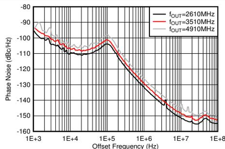
PLL イネーブル、 $f_{\text{VCO}} = 11796.48\text{MHz}$ 、 $f_{\text{REF}} = 491.52\text{MSPS}$ 、TX 出力で測定
