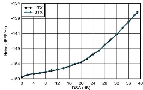
$f_{\text{DAC}} = 5898.24\text{MSPS}$ 、インターリーブモード、0.8GHzで整合、 $P_{\text{OUT}} = -13\text{dBFS}$
