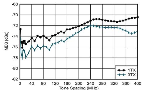
$f_{\text{DAC}} = 5898.24\text{MSPS}$ 、ストレートモード、 $f_{\text{CENTER}} = 0.85\text{GHz}$ 、0.8GHzで整合、各トーン -13dBFS
