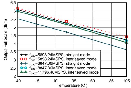
PCB とケーブルの損失を含む。  $A_{\text{OUT}} = -0.5\text{dBFS}$ 、 $\text{DSA} = 0$ 、 $0.8\text{GHz}$  整合あり
