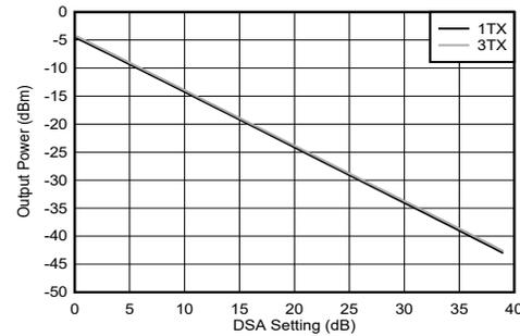
PCB とケーブルの損失を含む。
