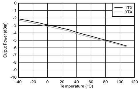
PCB とケーブルの損失を含む。
