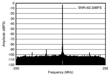
3.6GHz 整合あり、 $f_{\text{IN}} = 3610\text{MHz}$ 、 $A_{\text{IN}} = -3\text{dBFS}$
