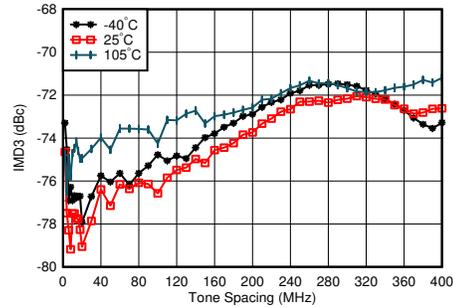
$f_{DAC} = 11796.48\text{MSPS}$ 、インターリーブモード、 $f_{CENTER} = 1.8\text{GHz}$ 、 $1.8\text{GHz}$ で整合、各トーン  $-13\text{dBFS}$ 、ワーストチャンネル
