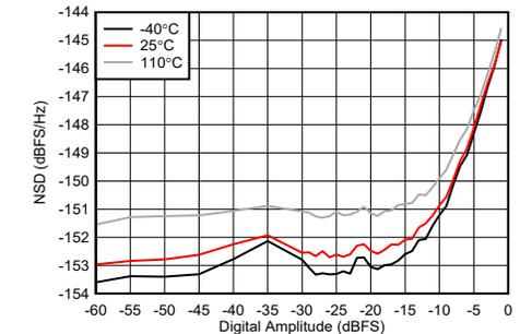
図 4-260. TX NSD とデジタル振幅との関係 (9.61GHz)
