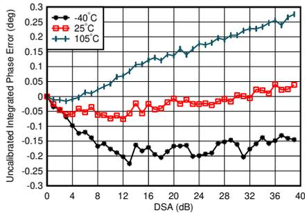
$f_{\text{DAC}} = 8847.36\text{MSPS}$ 、ストレートモード、2.6GHzで整合、全  $\text{DSA}$  設定にわたって  $25^\circ\text{C}$ での誤差が中位の大きさのチャンネル積分位相誤差 =  $\text{Phase}(\text{DSA 設定}) - \text{Phase}(\text{DSA 設定} = 0)$
