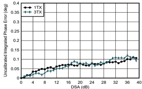
$f_{\text{DAC}} = 5898.24\text{MSPS}$ 、インターリーブモード、1.8GHzで整合
