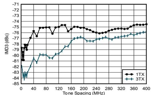
$f_{\text{DAC}} = 11796.48\text{MSPS}$ 、インターリーブモード、 $f_{\text{CENTER}} = 0.85\text{GHz}$ 、0.8GHzで整合、各トーン -13dBFS
