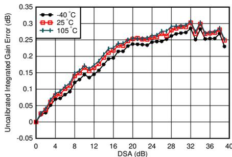
$f_{\text{DAC}} = 5898.24\text{MSPS}$ 、インターリーブモード、1.8GHz で整合
