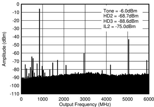
$f_{\text{DAC}} = 5898.24\text{MSPS}$ 、インターリーブモード、0.8GHz 整合あり、PCB とケーブルの損失を含む。ILn =  $f_s/n \pm f_{\text{OUT}}$ 。
