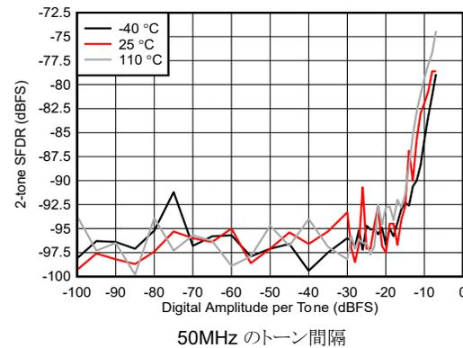
図 4-439. RX 2 トーン SFDR とデジタル振幅との関係 (8.11GHz)
