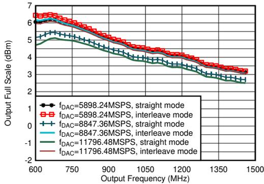
PCB とケーブルの損失を含む。  $A_{\text{OUT}} = -0.5\text{dBFS}$ 、 $\text{DSA} = 0$ 、 $0.8\text{GHz}$  整合あり
