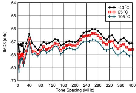
$f_{DAC} = 11796.48\text{MSPS}$ 、インターリーブモード、4.9GHzで整合、 $f_{CENTER} = 4.9\text{GHz}$ 、各トーン  $-13\text{dBFS}$ 、ワーストチャンネル
