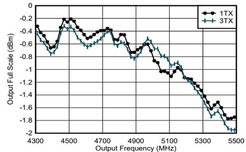
PCB とケーブルの損失を除く。 $A_{\text{OUT}} = -0.5\text{dBFS}$ 、 $\text{DSA} = 0$ 、4.9GHz 整合あり。
