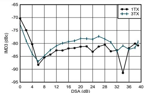
$f_{\text{DAC}} = 11796.48\text{MSPS}$ 、インターリーブモード、 $f_{\text{CENTER}} = 1.8\text{GHz}$ 、1.8GHzで整合、各トーン -13dBFS
