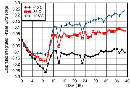
$f_{\text{DAC}} = 8847.36\text{MSPS}$ 、ストレートモード、2.6GHzで整合、全  $\text{DSA}$  設定にわたって  $25^\circ\text{C}$ での誤差が中央値であるチャンネル積分位相誤差 =  $\text{Phase}(\text{DSA 設定}) - \text{Phase}(\text{DSA 設定} = 0)$
