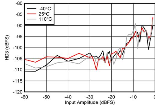
図 4-437. RX HD3 とデジタル振幅との関係 (8.11GHz)
