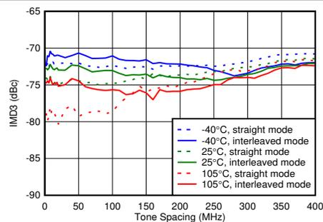
$f_{\text{DAC}} = 8847.36\text{MSPS}$ 、ストレートモード、 $f_{\text{CENTER}} = 2.6\text{GHz}$ 、 $2.6\text{GHz}$  で整合、各トーン  $-13\text{dBFS}$
