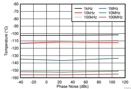
PLL イネーブル、 $f_{VCO} = 8847.36\text{MHz}$ 、 $f_{REF} = 491.52\text{MSPS}$ 、最小 LPF BW、TX 出力で測定
