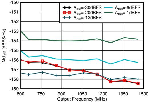
2.6GHzで整合、シングルトーン、 $f_{DAC} = 11.79648\text{GSPS}$ 、インターリーブモード、40MHzオフセット、 $\text{DSA} = 0\text{dB}$
