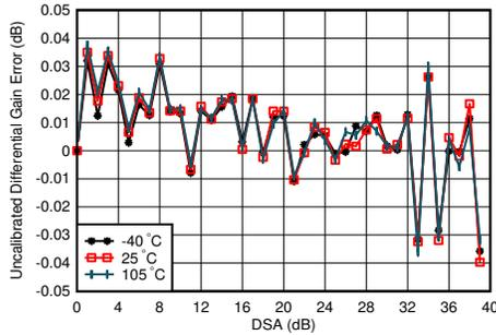
$f_{\text{DAC}} = 8847.36\text{MSPS}$ 、ストレートモード、2.6GHz で整合、全  $\text{DSA}$  設定にわたって  $25^\circ\text{C}$ での誤差が中央値であるチャンネル微分ゲイン誤差 =  $P_{\text{OUT}}(\text{DSA 設定} - 1) - P_{\text{OUT}}(\text{DSA 設定}) + 1$
