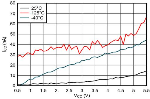
図 4-1. 電源電流と電源電圧との関係
