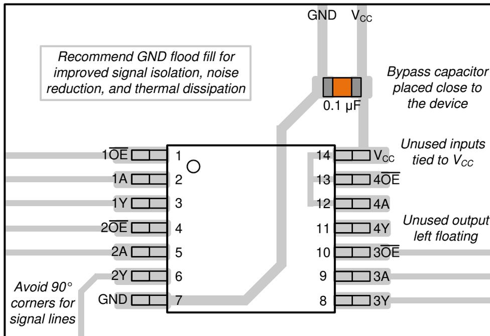
図 8-3. SNx4AHCT125 のレイアウト例
