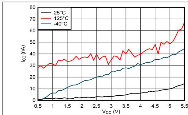
図 5-1. 電源電流と電源電圧との関係
