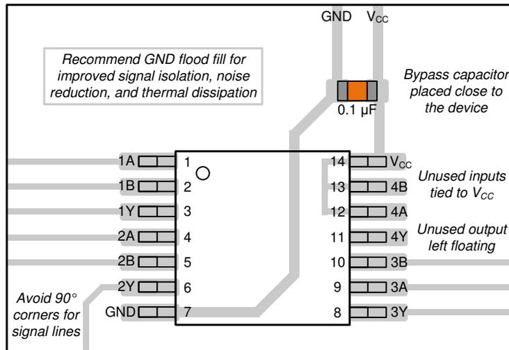
図 8-3. SNx4AHC32 のレイアウト例
