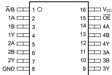
図 5-1. PW パッケージ、16 ピン TSSOP (上面図)
