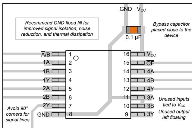
図 8-3. SN74AHC257-Q1 のレイアウト例
