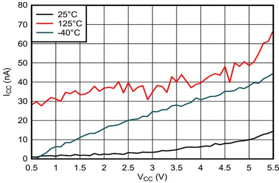
図 5-1. 電源電流と電源電圧との関係
