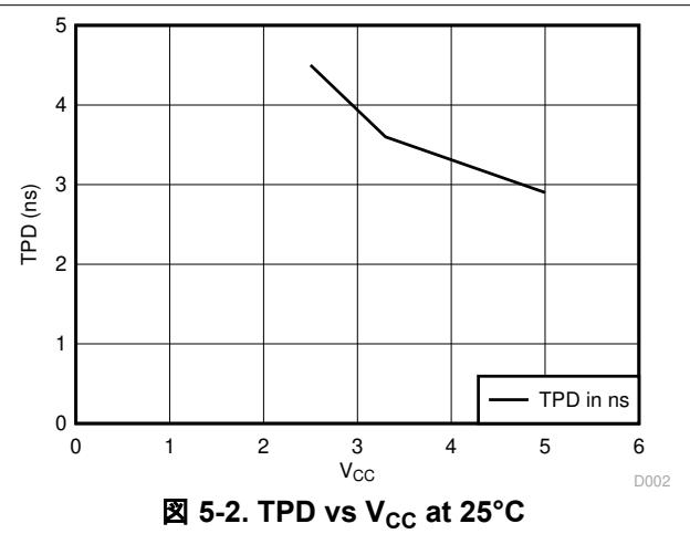
図 5-2. TPD vs  $V_{CC}$  at  $25^\circ\text{C}$
