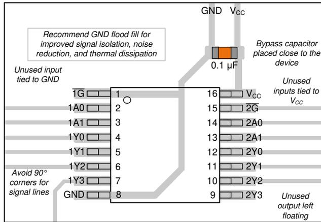
図 7-3. SN74AHC139 のレイアウト例
