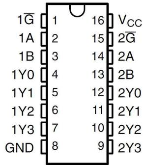
図 3-1. SN74AHC139 D、DB、DGV、N、NS、PW パッケージ (上面図)
