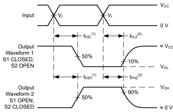
(1)  $t_{PLZ}$  と  $t_{PZH}$  の大きい方が  $t_{en}$  に相当します。
