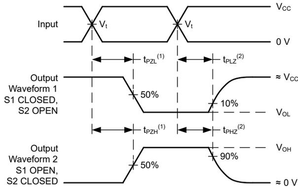
(1)  $t_{PZL}$  と  $t_{PZH}$  の大きい方が  $t_{en}$  に相当します。
