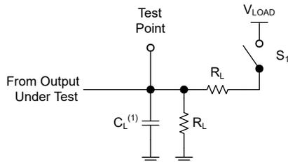
(1)  $C_L$  にはプローブとテスト装置の容量が含まれます。
