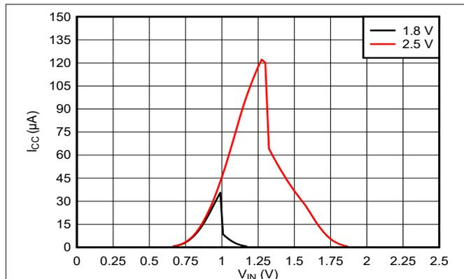
図 5-1. 電源電流と入力電圧との関係 (1.8V、2.5V 電源)
