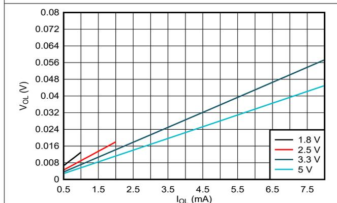
図 5-5. 出力電圧と Low 状態の電流との関係
