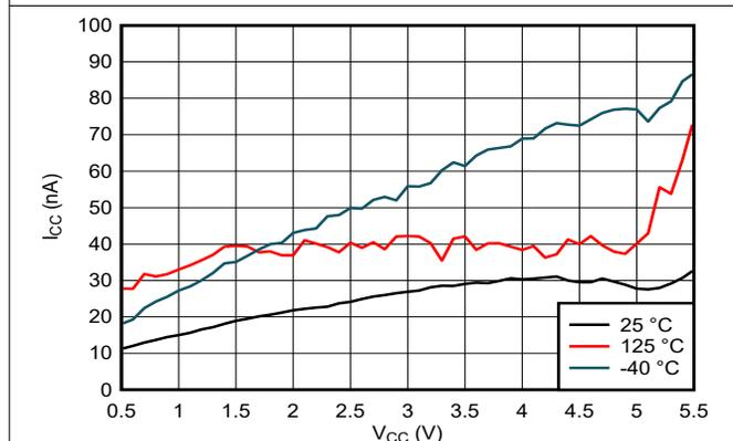
図 5-3. 電源電流と電源電圧との関係
