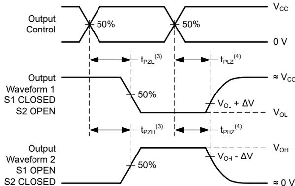
(3)  $t_{PZL}$  と  $t_{PZH}$  の大きい方が  $t_{en}$  に相当します。
