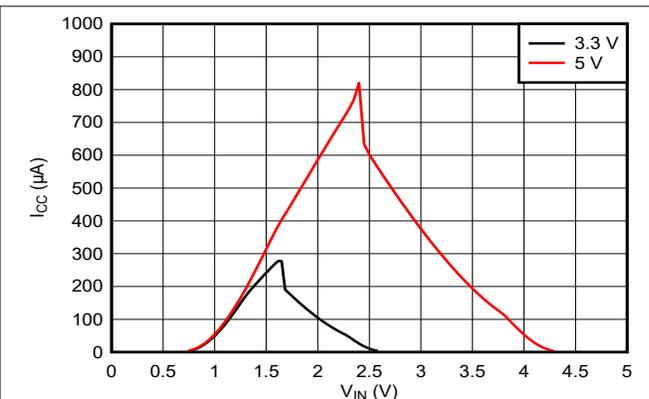
図 5-2. 電源電流と入力電圧との関係 (3.3V、5.0V 電源)
