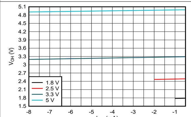
図 5-4. 出力電圧と High 状態の電流との関係
