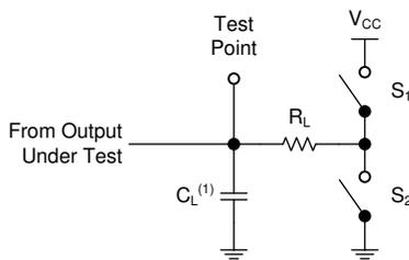
(1)  $C_L$  にはプローブとテスト装置の容量が含まれます。
