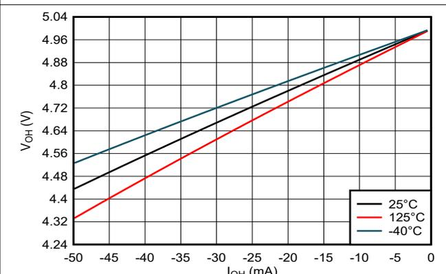
図 5-6. High 状態における出力電圧と電流の関係、5V 電源
