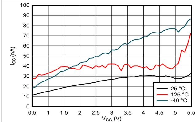
図 5-3. 電源電流と電源電圧との関係
