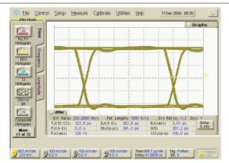
図 5-22. レシーバ出力アイ パターン 250Mbps、2<sup>15</sup>–1 PRBS、V<sub>CC</sub> = 3.3V |V<sub>ID</sub>|= 800 mV<sub>PP</sub>、V<sub>IC</sub> = 1V
