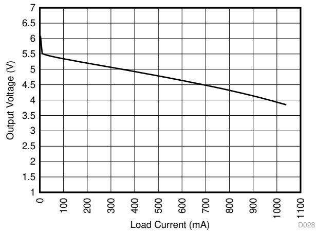
SN6505A + Wurth 750316031 V_{CC} = 3.3 V
