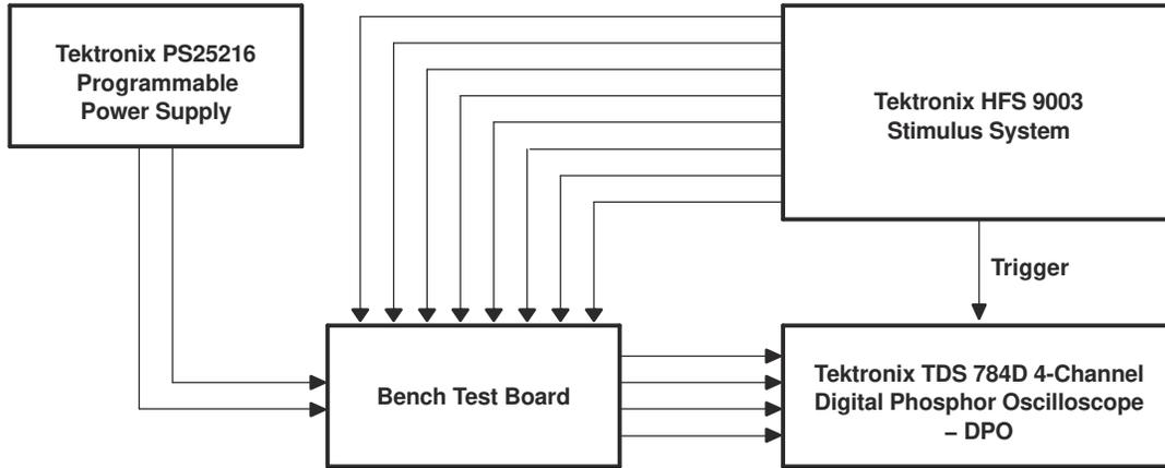
図 8-6. Equipment Setup
