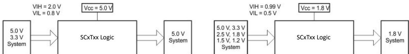
図 6-2. SCxT の昇圧および降圧変換の例
