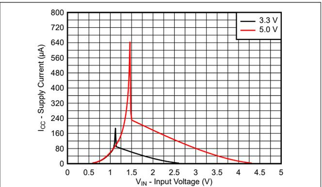
図 5-2. 入力電圧に対する電源電流、3.3V および 5.0V 電源
