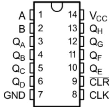
図 4-1. PW パッケージ 14 ピン TSSOP (上面図)
