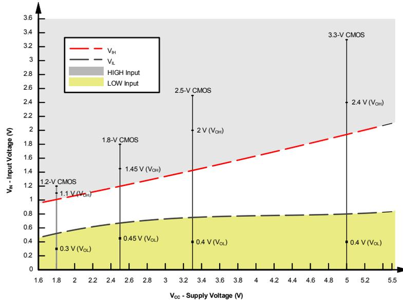
図 6-1. SCxT の入力電圧レベル
