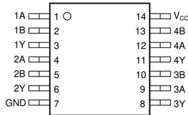
図 5-1. PW Package, 14-Pin TSSOP (Top View)
