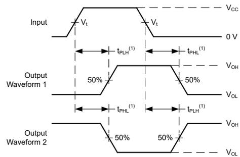
(1)  $t_{PLH}$  と  $t_{PHL}$  の大きい方が  $t_{pd}$  に相当します。
