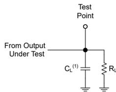
(1)  $C_L$  にはプローブとテスト装置の容量が含まれます。
