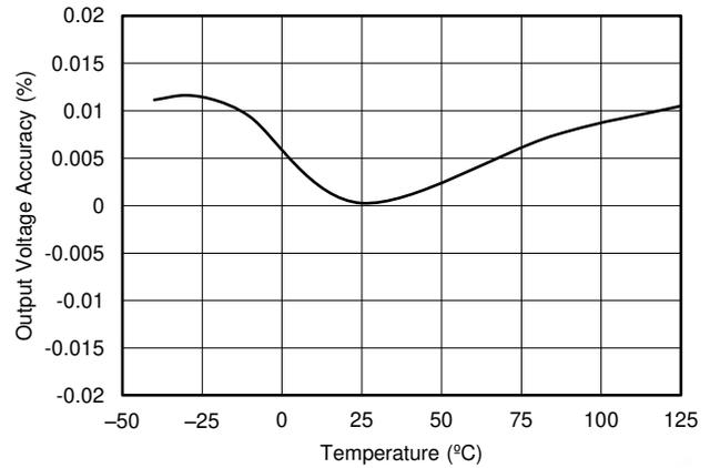
図 6-4. 出力電圧精度と温度との関係
