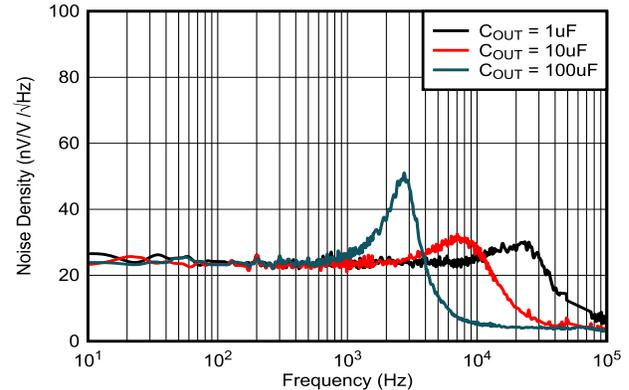
図 6-46. 10Hz~100kHz のノイズ性能
