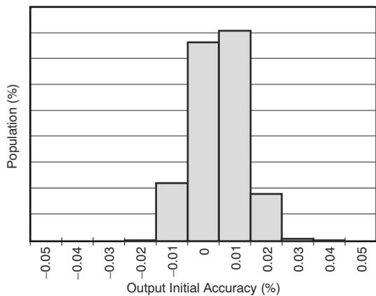
図 6-3. 出力電圧の初期精度
