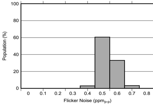
図 6-45. 0.1Hz~10Hz の電圧ノイズ分布
