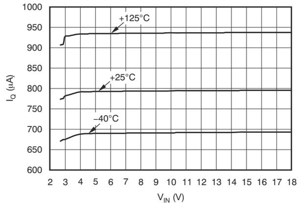
図 6-10. 静止電流と入力電圧との関係
