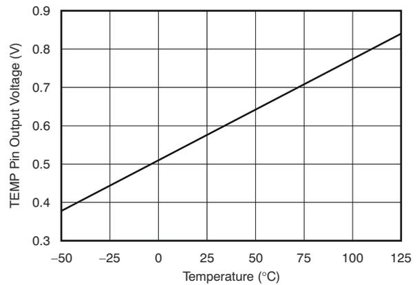
図 6-8. TEMP ピンの電圧と温度との関係
