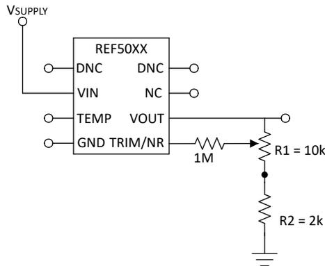
図 8-5. TRIM/NR ピンを使用した  $V_{OUT}$  の調整
