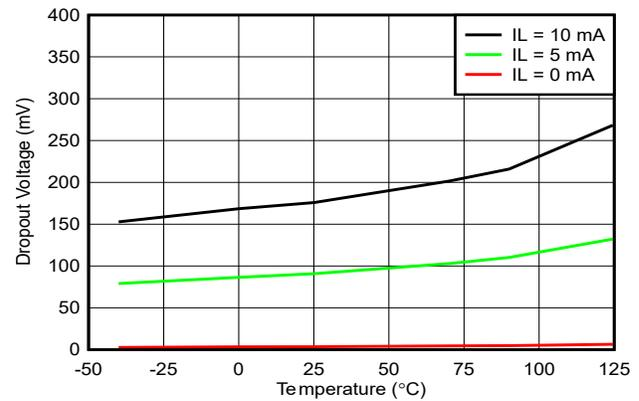
図 6-44. ドロップアウト電圧 vs 温度
