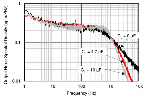
図 7-34. 出力電圧ノイズのスペクトラム
