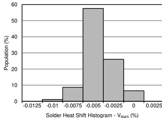
図 8-3. 半田付けの熱による変動、 $V_{BIAS}$  (%)
