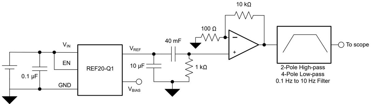
図 8-9. 0.1Hz~10Hz のノイズ測定のセットアップ
