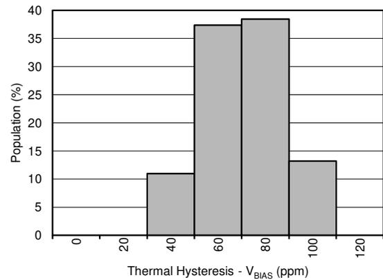
図 7-38. 熱ヒステリシスの分布 ( $V_{BIAS}$ )
