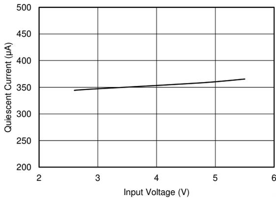
図 7-31. 静止電流と入力電圧との関係
