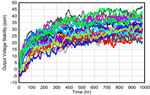
図 8-4. 長期安定性 – 1000 時間 ( $V_{\text{REF}}$ )
