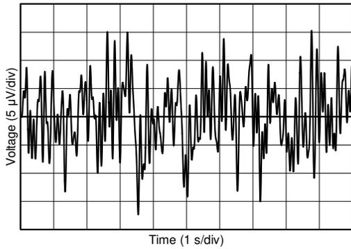
図 8-7. 0.1Hz~10Hz のノイズ ( $V_{REF}$ )
