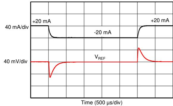
$C_L = 10\mu\text{F}$   $I_L = \pm 20\text{mA}$  ステップ
