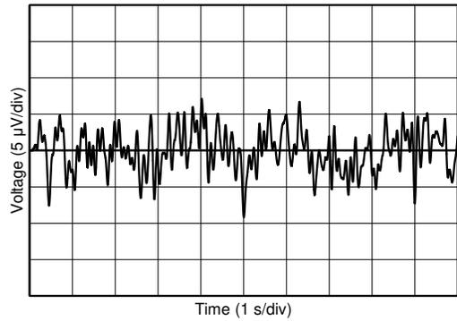
図 8-8. 0.1Hz~10Hz のノイズ ( $V_{BIAS}$ )
