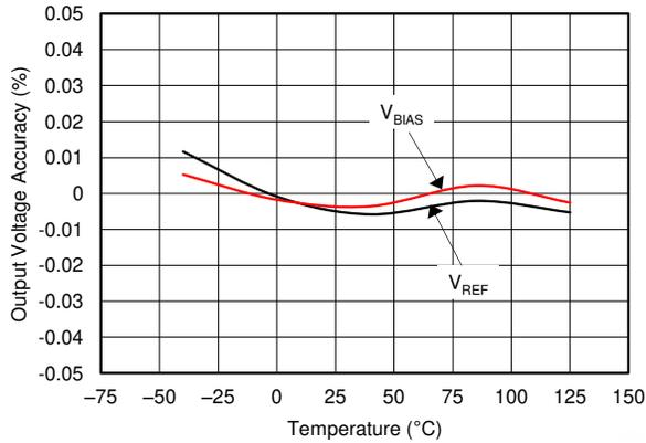
図 7-9. 出力電圧精度 ( $V_{REF}$ ) と温度との関係
