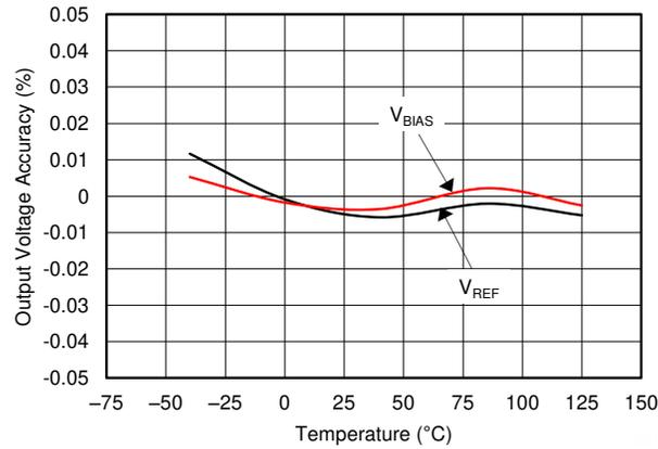
図 9-1. V<sub>REF</sub> と V<sub>BIAS</sub> のトラッキングと温度との関係
