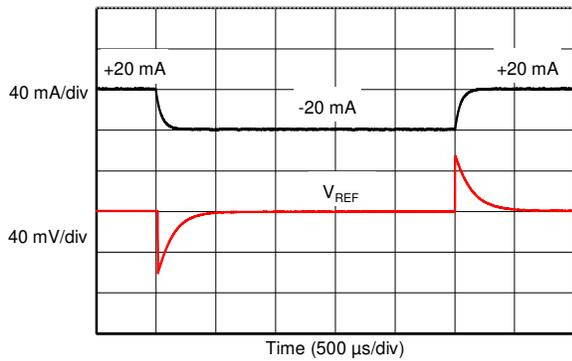
$C_L = 1\mu\text{F}$   $I_L = \pm 20\text{mA}$  ステップ
