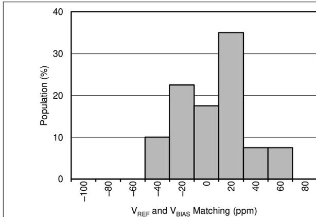
図 10-4. V<sub>REF</sub> - 2 × V<sub>BIAS</sub> の分布 (T<sub>A</sub> = 25°C)
