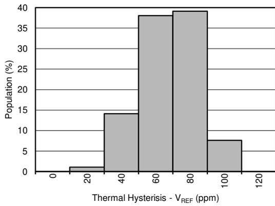
図 7-37. 熱ヒステリシスの分布 ( $V_{REF}$ )
