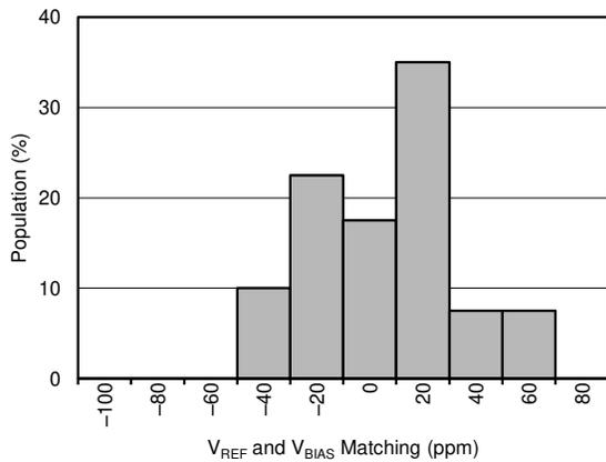
図 7-5.  $V_{REF} - 2 \times V_{BIAS}$  の分布
