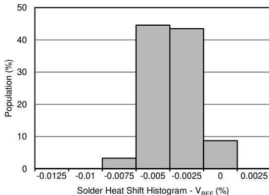
図 8-2. 半田付けの熱による変動、 $V_{REF}$  (%)
