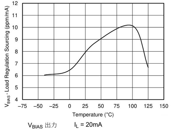
図 7-14. 負荷レギュレーション・ソースと温度との関係 ( $V_{BIAS}$ )
