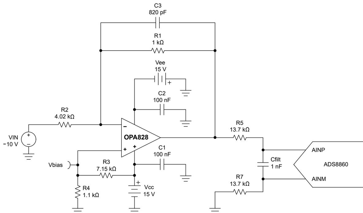
図 8-1. OPA828 を SAR ドライバとして構成
