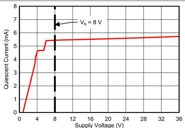
図 6-16. 静止電流と電源電圧との関係
