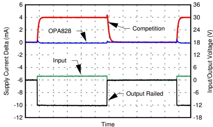
図 7-6. 過負荷出力時の電源電流の変化
