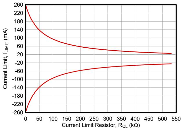
出力電流と電流制限抵抗の構成
