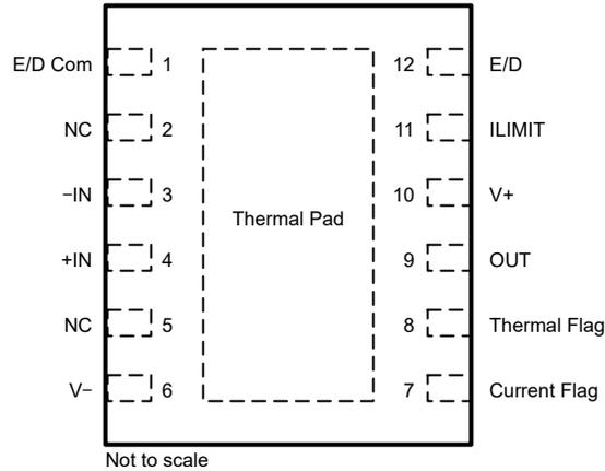
图 5-1. DNT (12-Pin WSON) Package, Top View
