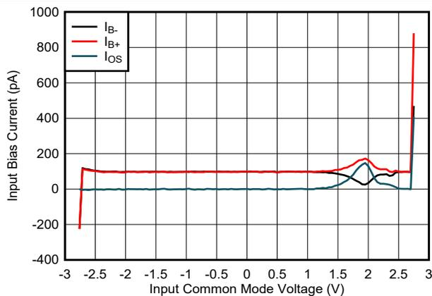
図 6-11. 入力バイアス電流と同相電圧との関係
