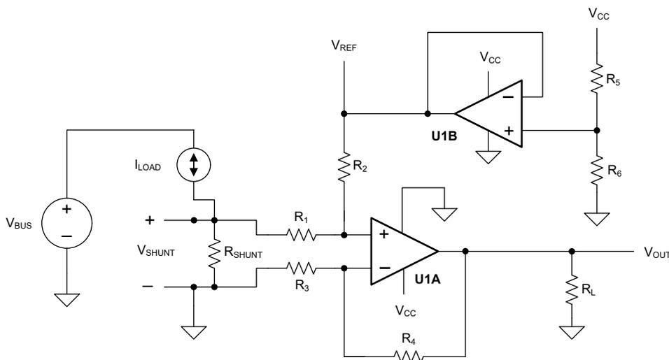
図 8-1. 双方向電流センシング回路図
