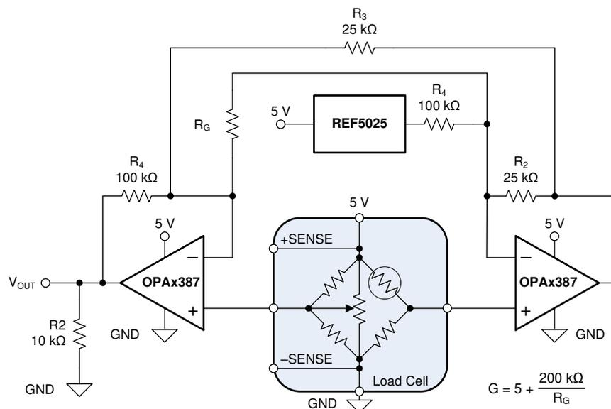
図 8-3. ロード・セル測定の回路図
