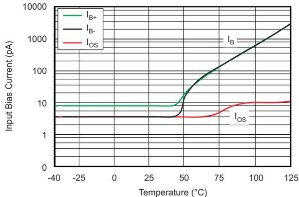
図 5-8. 入力バイアス電流と温度との関係
