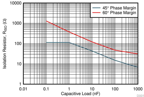
図 7-6. R<sub>ISO</sub> と C<sub>LOAD</sub> との関係
