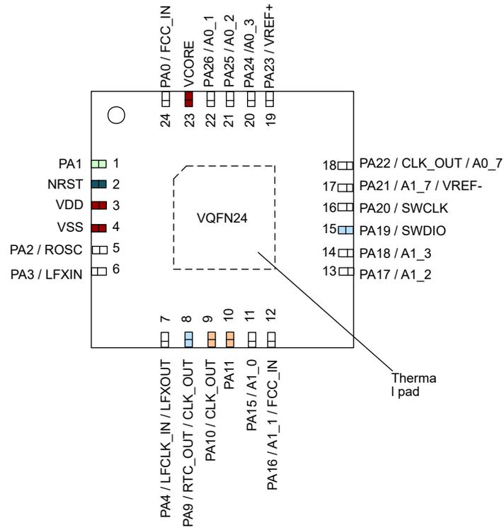
図 6-7. 24 ピン RGE (VQFN) (上面図)
