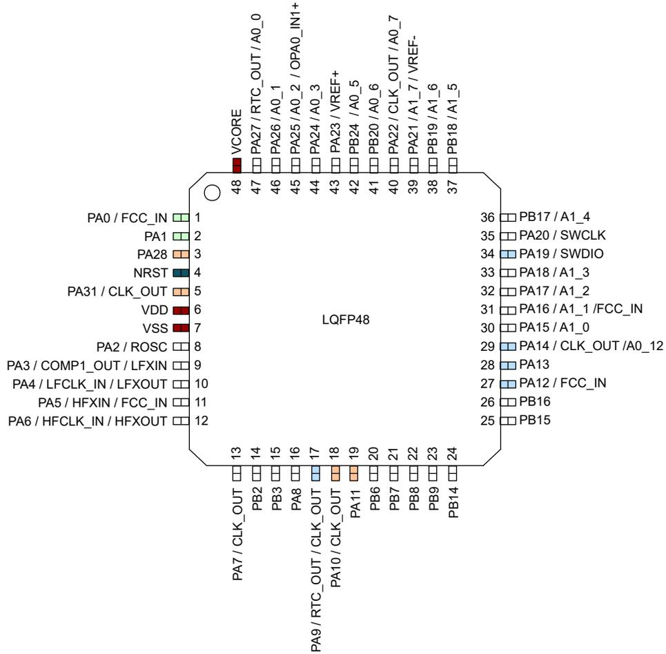
図 6-3. 48 ピン PT (LQFP) (上面図)
