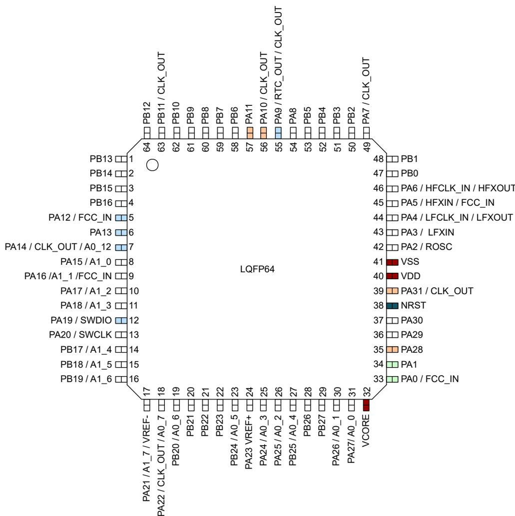
図 6-2. 64 ピン PM (LQFP) (上面図)
