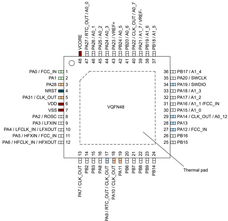
図 6-4. 48 ピン RGZ (VQFN) (上面図)
