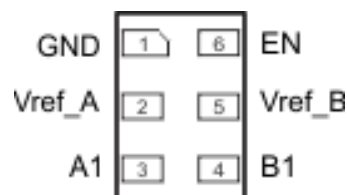
図 5-1. LSF0101 DRY パッケージ、6 ピン SON (透過上面図)
