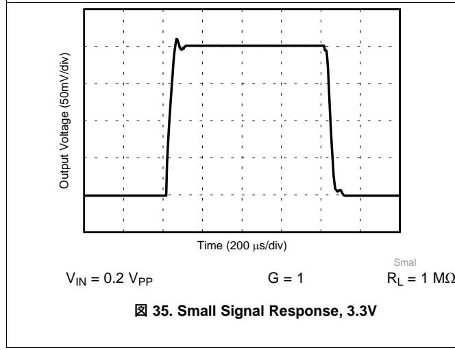
図 35. Small Signal Response, 3.3V
