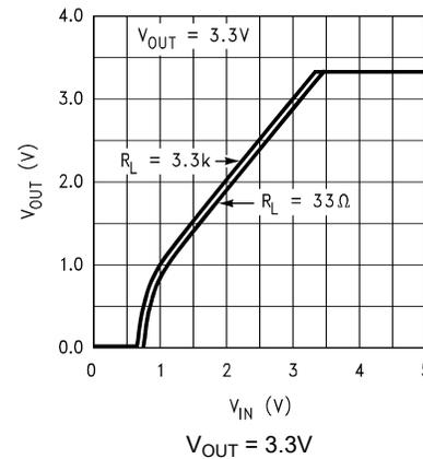
图 5-6. Output Voltage vs  $V_{IN}$  (Legacy Chip)
