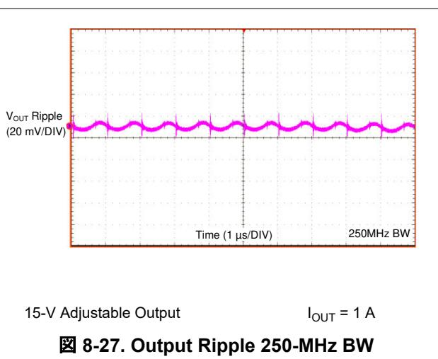
图 8-27. Output Ripple 250-MHz BW
