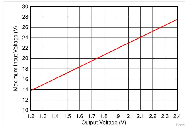
图 6-1. Maximum Input Voltage for  $V_{OUT} < 2.5\text{ V}$
