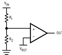
Figure 23. Threshold Detector
