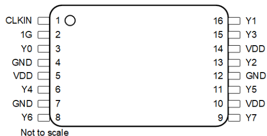
図 5-7. LMK1C1108A、16 ピン PW TSSOP パッケージ (上面図)
